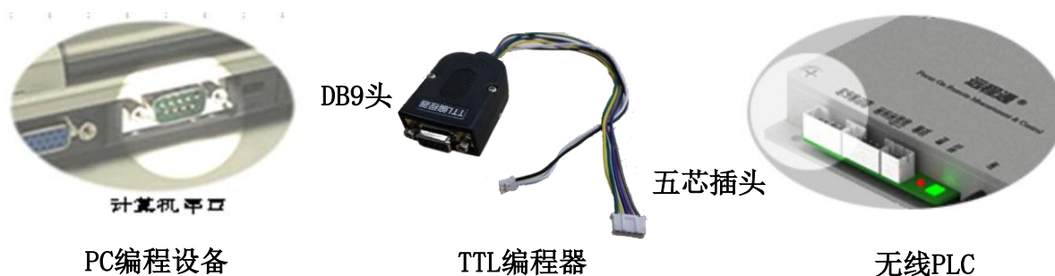
图 3-1 无线 PLC 与编程设备连续示意图
